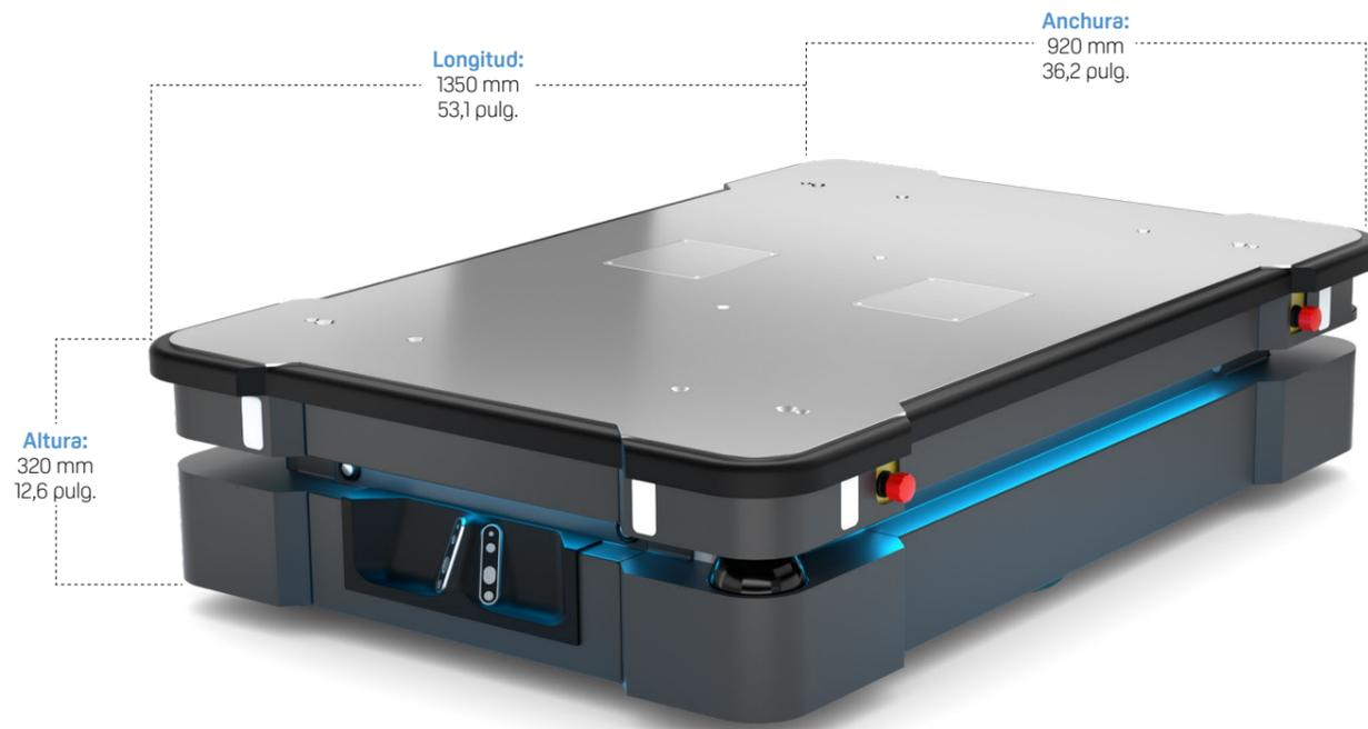
El **MiR500** ha sido diseñado para automatizar el transporte de cargas pesadas y palés en diferentes sectores.
