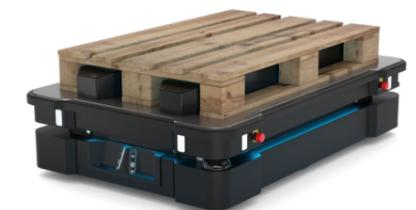
El **MiR1000** automatiza y optimiza el transporte interno de cargas pesadas y palés. Con una capacidad de carga de 1.000 kg, es el robot más potente de MiR, e incluso en entornos muy dinámicos es capaz de transportar cargas pesadas sin necesidad de medidas de seguridad exteriores.
